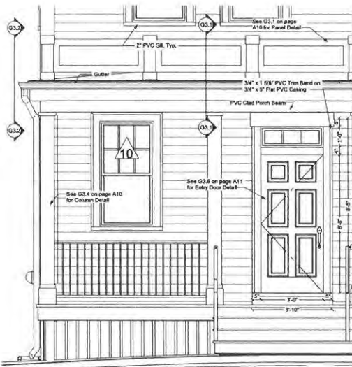
G3 Left Entry Detail Scale: 1/2" = 1'-0"
