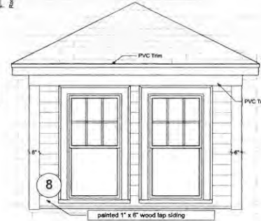
G2 Dormer Detail Scale: 1/2" = 1'-0"
