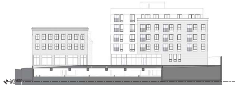
2 SOUTH (LINDEN WAY) ELEVATION SCALE: 1/8" = 1'-0"
