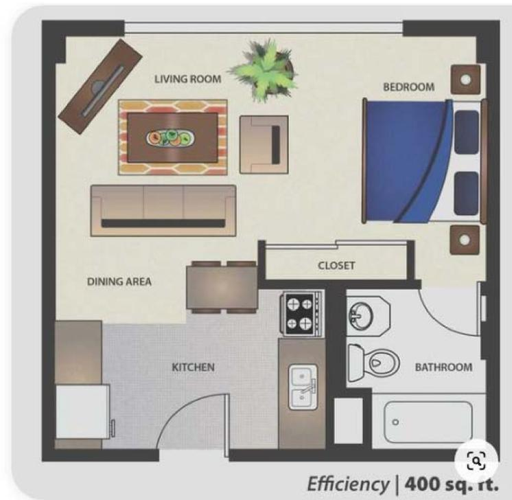
EXAMPLE EFFICIENCY UNIT FLOOR PLAN - 400SF
