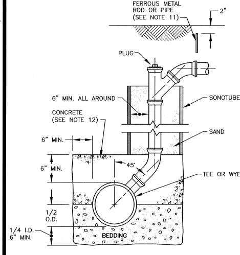
NO BACKFILLING BEFORE CONCRETE HAS TAKEN INITIAL SET (7 HRS. MIN.). BACKFILLING TO BE BROUGHT UP EVENLY ON ALL SIDES.
