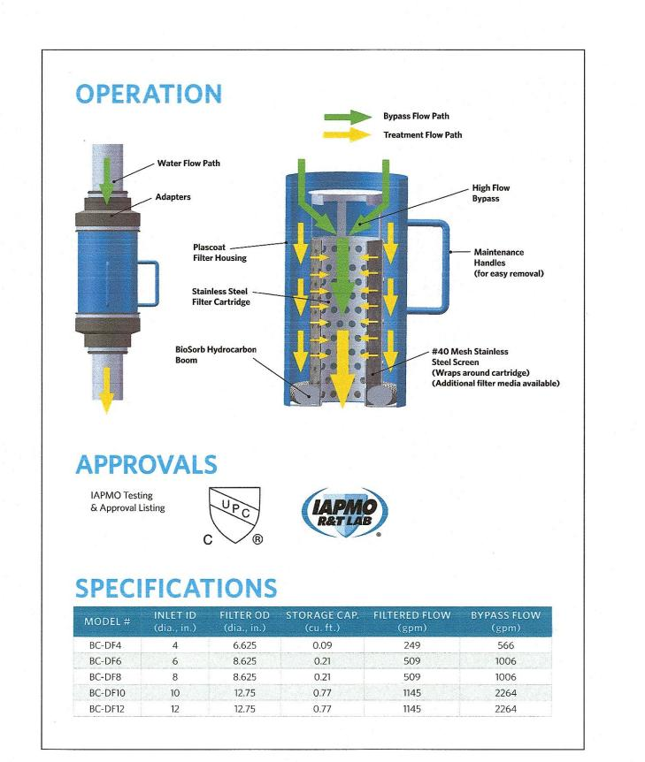
ROOF DRAIN FILTER OPERATION
