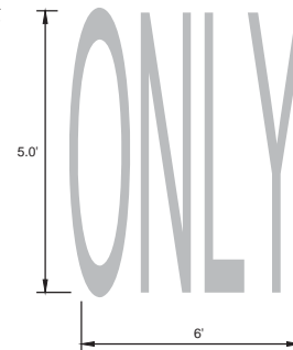
16 PAVEMENT LETTERING DETAIL N.T.S.
