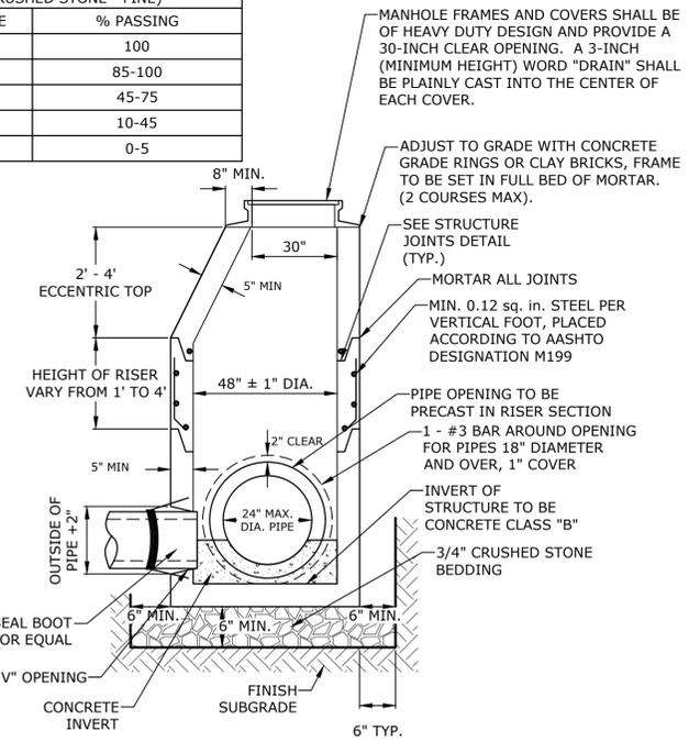
**4" DIAMETER DRAIN MANHOLE**
