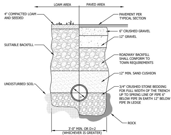
**TYPICAL DRAINAGE TRENCH DETAIL**
