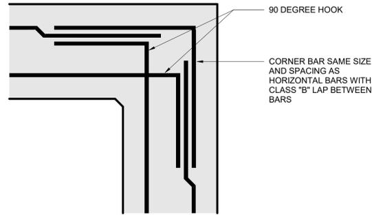
**7** REINFORCING - DOUBLE MAT REINFORCING AT CORNER
