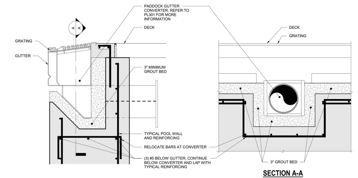
**5** REINFORCING - GUTTER CONVERTER
