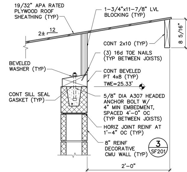
**3** TYP BEVELED PT 4x8 BLOCKING TO 8" REINF CMU WALL CONN DETAIL
