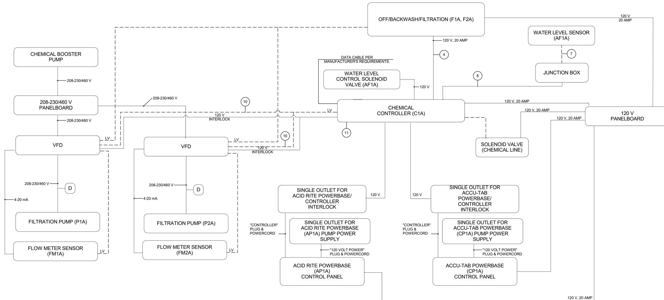
**SEQUENCE OF OPERATIONS - SWIMMING POOL WITH MANUAL BACKWASH SAND FILTER SYSTEM**
