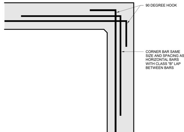
**6** REINFORCING - SINGLE MAT REINFORCING AT CORNER
