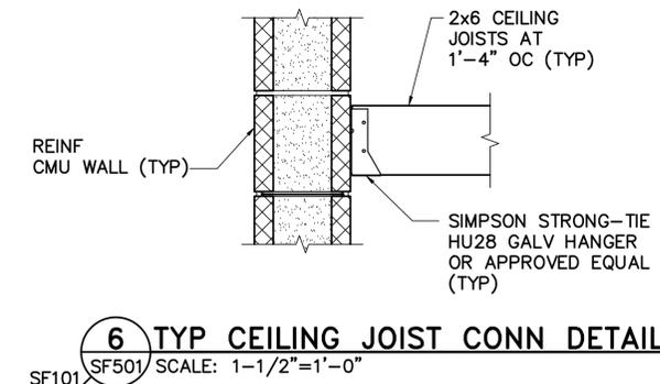
**6** TYP CEILING JOIST CONN DETAIL
