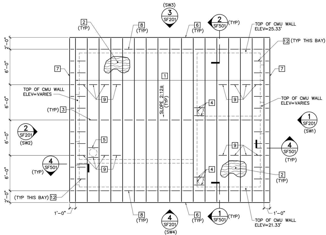
**1 PUMP HOUSE ROOF FRAMING PLAN**
