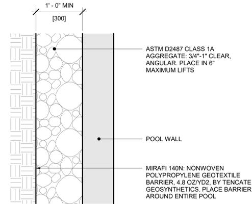
**4** POOL WALL BACKFILL
