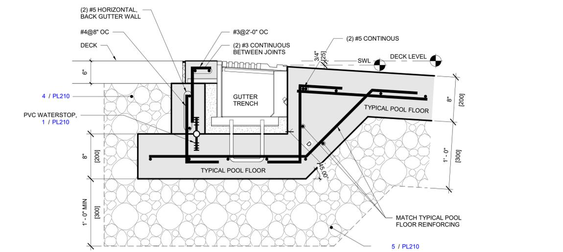
**3** REINFORCING - ZERO DEPTH GUTTER
