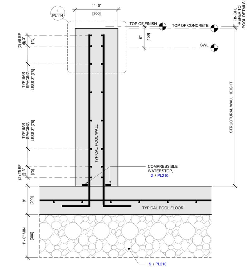
**1** REINFORCING - TYPICAL COMMON WALL
