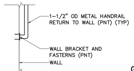
**B RAILING TO WALL PLAN DETAIL**
